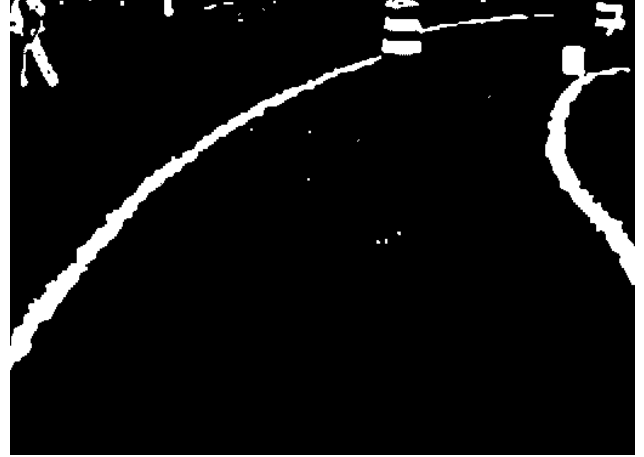
(d) Combination of edge detector and white filter.
